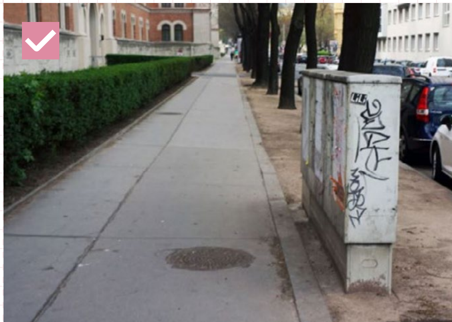
04 Príklad umiestnenia RIS v zelenom páse/aleji. Ideálne by však RIS mala byť umiestnená na osi stromoradia. Viedeň .
