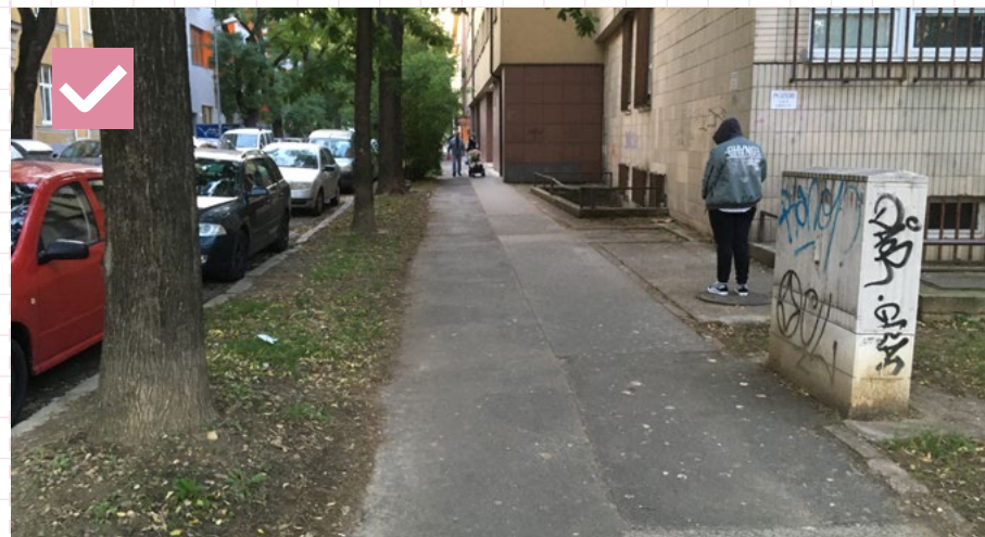
23 Vhodný príklad odstupu RIS od stromu. RIS nesmie byť umiestnená v ochrannom pásme koreňovej sústavy, ktorá sa rovná min. vzdialenosti 4 × obvod kmeňa meraného vo výške 1,3 m od povrchu kmeňa. Námestie slobody, Bratislava
