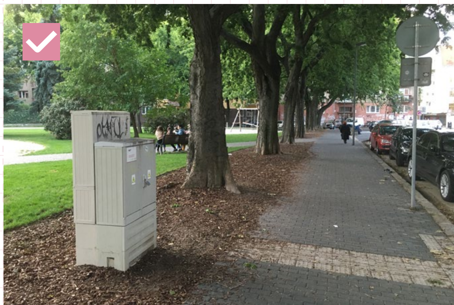
02 Príklad umiestnenia RIS na osi so susediacimi prvkami, v tomto prípade stromami, za dodržania vzájomného odstupu v zmysle týchto princípov a štandardov. Safárikovo námestie, Bratislava
